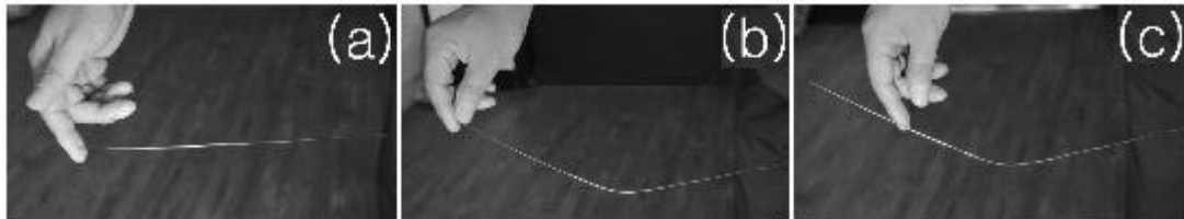
그림 1. 탄성이 없는 구리선의 변형 과정
