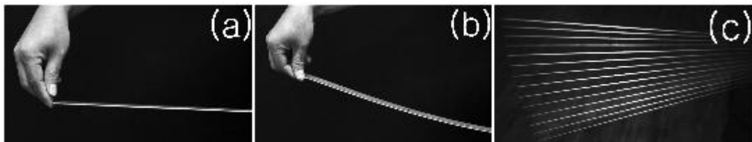
그림 2. 탄성을 가진 stainless steel ruler의 변형 과정
